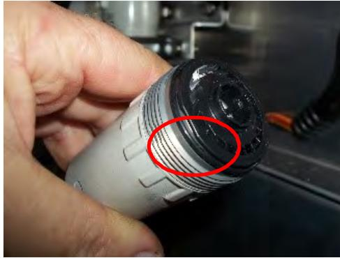
5. Vérifier s'il y a des débris dans les deux boîtiers et les éliminer le cas échéant. Vérifier que rien ne bloque le drainage du bas sur les boîtiers de filtres.
