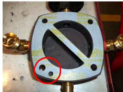
5. Prendre la plaque de vanne de sortie avec la ligne centrale et la positionner par rapport au trou indicateur.
