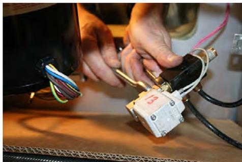
7. Pour remonter une WDV, appliquer de la pâte de Téflon sur le raccord en laiton et exécuter les instructions de démontage en sens inverse.
