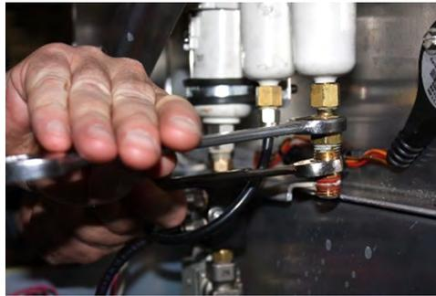
4. Noter l'orientation du clapet anti-retour.
