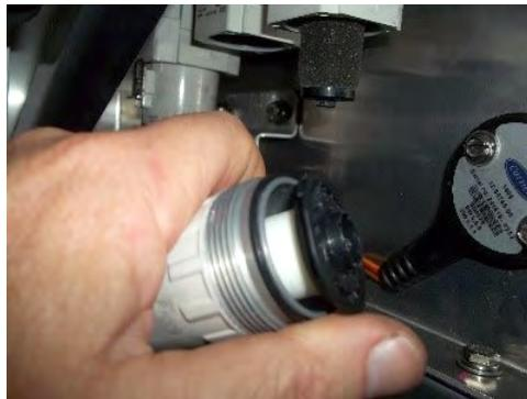
7. Puis remettre le boîtier en place sur le corps du filtre en tournant vers la droite jusqu'à ce qu'il soit serré.
