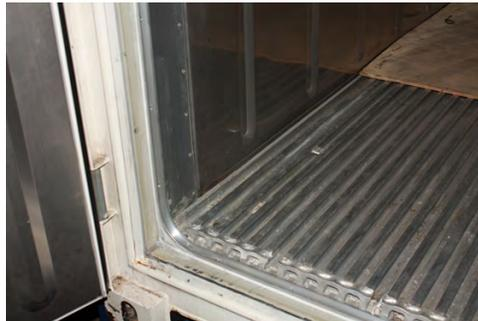
2. Déplier complètement le rideau de porte. Placer la flèche « CENTRE » au centre de l'ouverture de la porte (Figure 2a). Le signe « CENTRE » doit être lisible car c'est l'extérieur du rideau.
