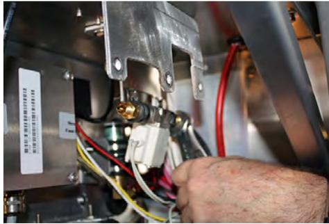
5. Couper les liens qui retiennent les fils de la bobine EN à l'arrière du faisceau de câbles au point d'épissure vers le groupe. Puis, couper les fils au niveau de l'épissure du faisceau.
