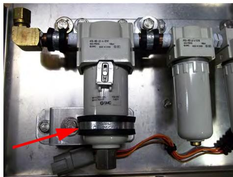
3. Abaisser l'attache de verrouillage et tourner d'un quart de tour vers la droite, lâcher le récipient.
