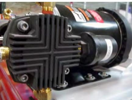
9. Retirer les vieux joints de compression placés sur les tuyaux de croisement et remplacer les joints de compression. Puis les monter sur la première tête à l'aide d'une clé 3/4". Ne pas trop serrer.
