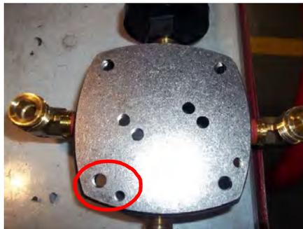
7. Positionner le joint d'étanchéité sans matériau central sur la feuille d'habillage. Aligner les deux trous indicateurs.
