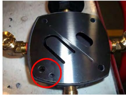
6. Réutiliser la plaque de vanne en positionnant le trou indicateur de la plaque par rapport à la vanne de refoulement. Si l'installation est correcte, deux trous sont positionnés sur la vanne de refoulement et deux trous laissent voir la tête. S'il n'est pas possible de voir la tête à travers les deux trous adjacents, cela signifie que la feuille d'habillage n'est pas placée correctement.
