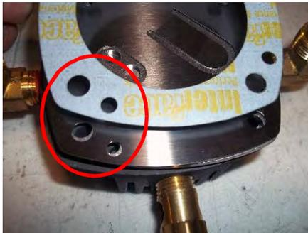
8. Placer les boulons de tête dans les deux trous pour conserver l'alignement du joint et des plaques et monter la tête sur le cylindre. Serrer manuellement les quatre boulons. Puis tourner le vilebrequin pour vérifier que le piston ne touche pas la tête. S'il ne touche pas la tête, serrer les boulons de la tête à un couple de 150 à 160 in-lb. (17 à 18 Nm) et vérifier à nouveau. Si la tête touche le piston, revenir à l'étape 3 et réaligner le cylindre.
