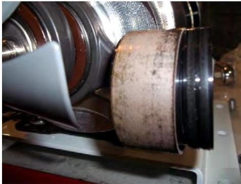
7. Vérifier si le piston et les cloisons du cylindre portent des signes de dommages ou de décapage.
