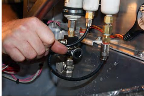
4. Tourner le raccord en acier inoxydable situé au fond du séparateur d'eau avec une clé 11/16" tout en tenant le raccord en laiton avec une clé 9/16".
