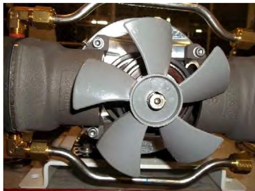
5. Déposer le cylindre du compresseur d'air en retirant les boulons hexagonaux 2 - 3/16" et en retirant le piston. Ne pas endommager le ventilateur. Jeter les boulons, ne pas les réutiliser.
