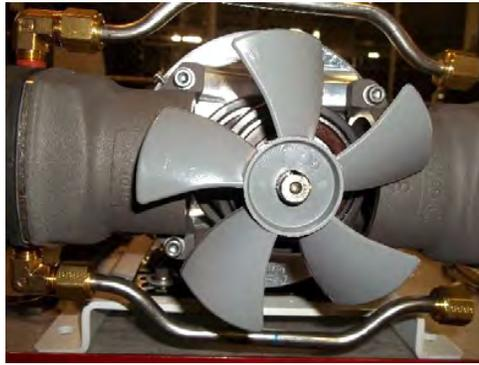
5. Déposer le cylindre du compresseur d'air en retirant les boulons hexagonaux 2 - 3/16" et en retirant le piston. Ne pas endommager le ventilateur. Jeter tous les composants sauf la traverse.
