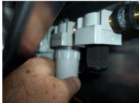
8. Remettre le joint torique sur le premier boîtier de filtre et remonter ce dernier sur le corps du filtre en tournant vers la droite.
