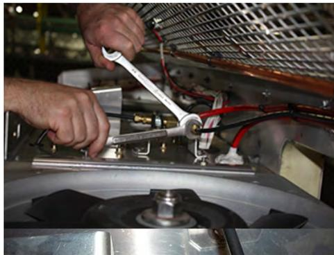
4. Avec une clé 11/16" pour le connecteur en té et une clé 11/16" pour le connecteur de conduite d'air, retirer le connecteur de conduite d'air. L'orifice se trouve sous l'attache avec amortissement. L'orifice se retire normalement avec le connecteur de conduite d'air, sinon, il est possible de le retirer plus avant en retirant l'attache avec amortissement et en utilisant une clé 9/16".
