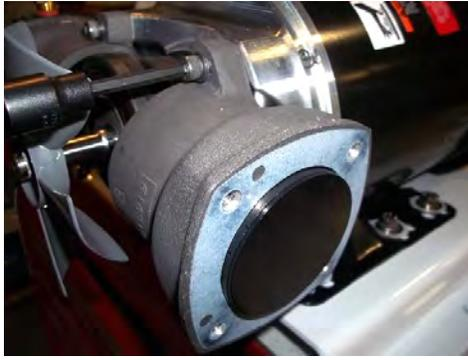
6. Déposer le guide et les bagues du piston.
