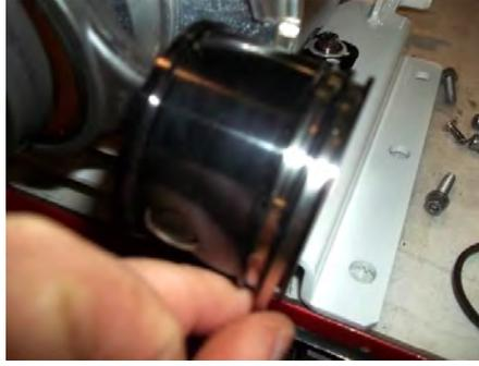
2. Monter la bague noire par-dessus la bague argentée du piston. Ouvrir légèrement pour passer par-dessus le piston et faire glisser en place. Décaler la fente de la bague de 180 degrés.
