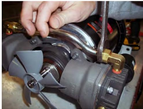
3. Retirer la tête dont les écrous de traverse sont desserrés avec une clé hexagonale 3/16". Retirer les quatre boulons de tête et retirer l'ensemble de tête y compris les plaques de vanne. Jeter tous les composants sauf la traverse.
