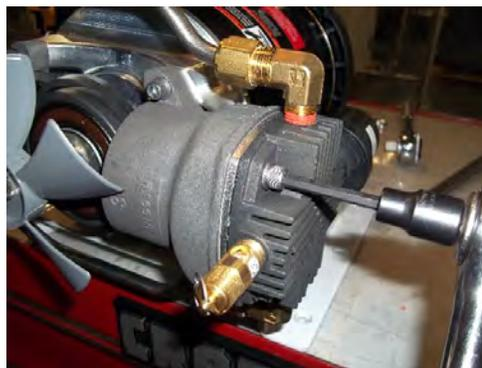
4. Déposer les traverses du compresseur d'air à l'aide d'une clé 3/4".
