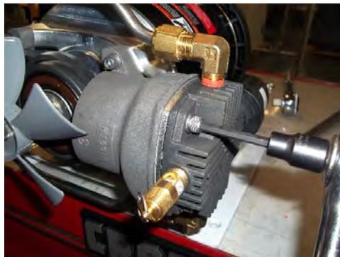
4. Déposer les traverses du compresseur d'air à l'aide d'une clé 3/4".
