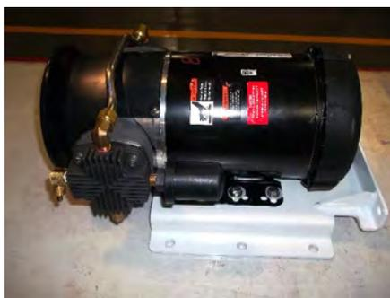
12. Remettre en place le compresseur d'air sur l'appareil.
