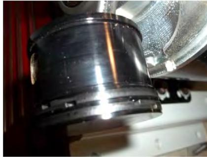
3. Tenir les bagues presseuses en place et faire glisser le cylindre par-dessus le piston. Tenir en place avec les deux boulons à goupille hexagonaux fournis dans le kit. Tourner le compresseur de façon à ce que le piston soit placé en haut du cylindre. Positionner le cylindre de façon à ce que le piston ne dépasse pas le haut du cylindre. Serrer à un couple de 150 à 160 in-lb. (17 à 18 Nm).
