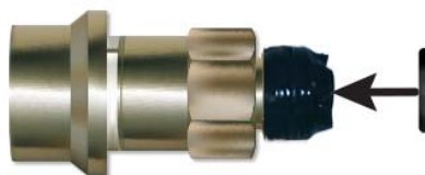
Figura 7.7 Instalación del O-ring - Deslice el O-ring
