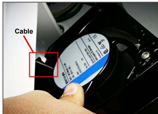
Figura 7.15 Retiro del ventilador del VFD
