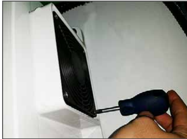
Figura 7.15 Remoção do ventilador do VFD
