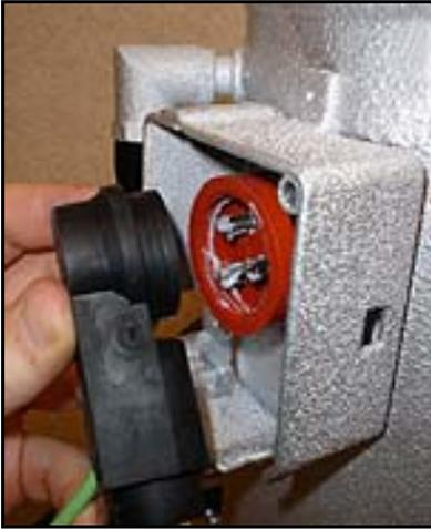
**Figura 7.10 Enchufe de alimentación asegurado**
