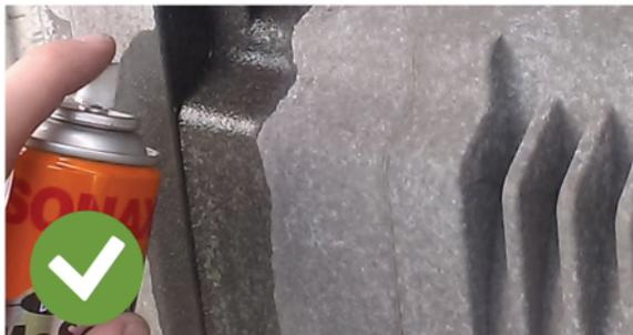
Aplicar aerosol de penetración o líquido para soltar los pernos de haber corrosión
