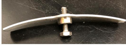
13. Revise la posición del sujetador. Deberá estar perfectamente alineado con la carcasa y no debería moverse si se intenta rotar con los dedos. Si esta desalineado, ajústelo a su posición correcta.
