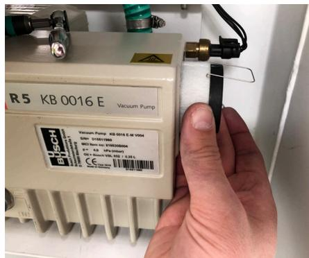
11. Coloque el adaptador (818725A) al filtro. Asegúrese que el pin del filtro se encuentre entre 2 dedos del adaptador y sea cuidadoso de no instalar el adaptador entre el cable sujetador y el filtro. Suavemente posicione la tapadera y apriete los 4 nuevos tornillos proporcionado con el adaptador del filtro con un torque de 1 Nm, luego apriete los 4 tornillos con un torque de 3 Nm.
